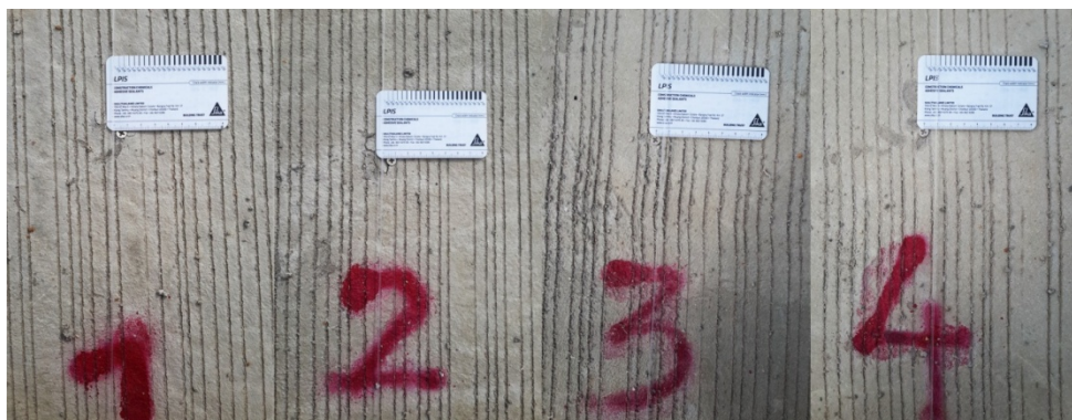
ภาพที่ 32 การเคลื่อนตัวของ CRCP ที่จุดปลาย
