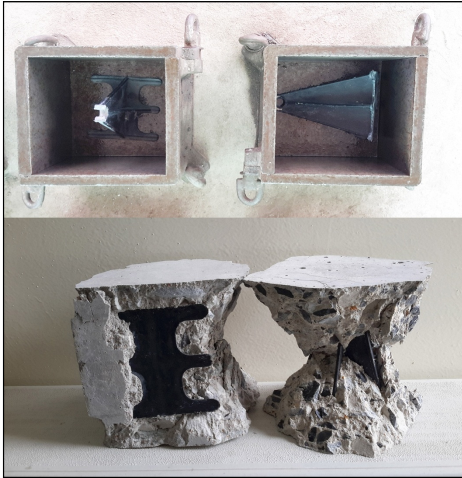
ภาพที่ 14 แสดงตัวอย่างการฝัง Bar Chair ในแท่งคอนกรีตทดสอบกำลังรับแรงอัด
